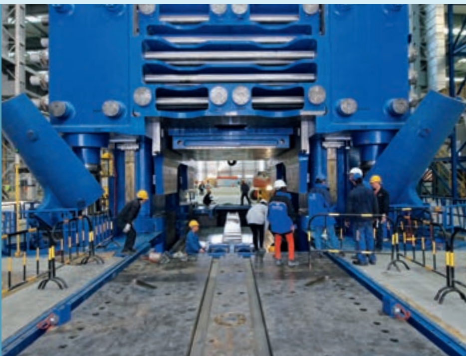
Die Laufholmverriegelung der 500-MN-Press
