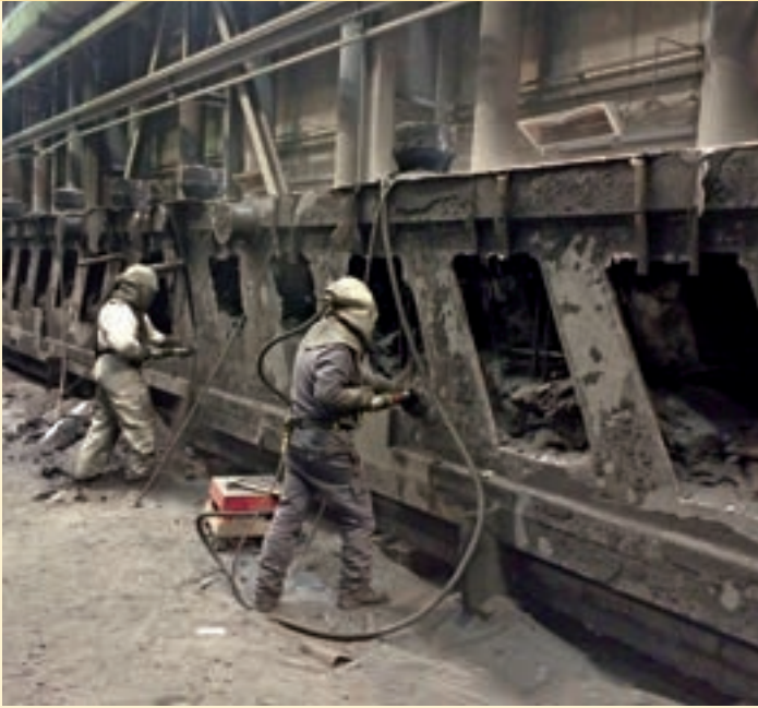
Schleifen und Entgraten des Gussteils in der Putzerei
