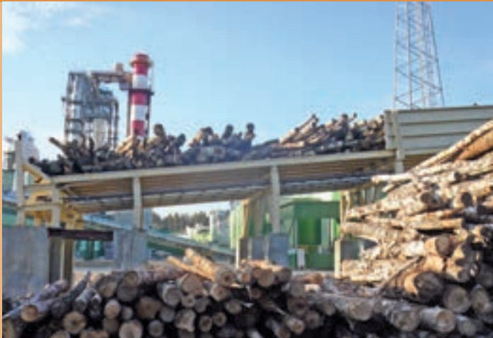
Zuführung des Materials – vom Entrinden zum Hacken
