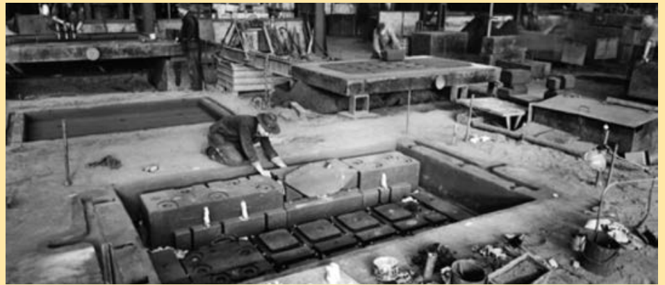
Formen eines Maschinenbettes in den 60er Jahren
