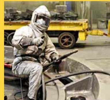
Mechanische Bearbeitung eines Maschinenträgers bei Siempelkamp
