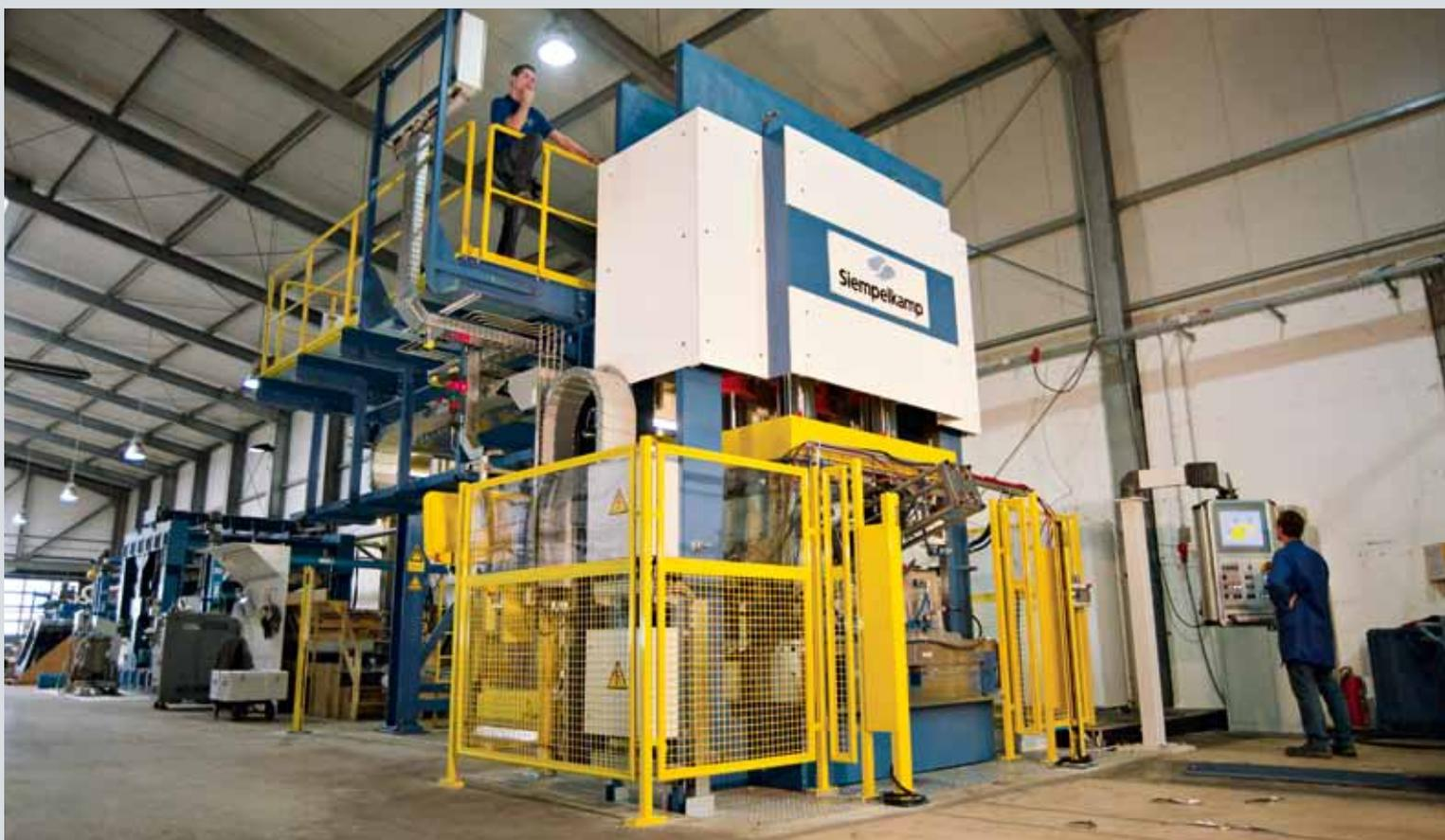
Spezialpresse mit Beschickvorrichtung für RTM und Organoblech
