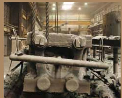
Ziehen des Gussteils aus der Formgrube
