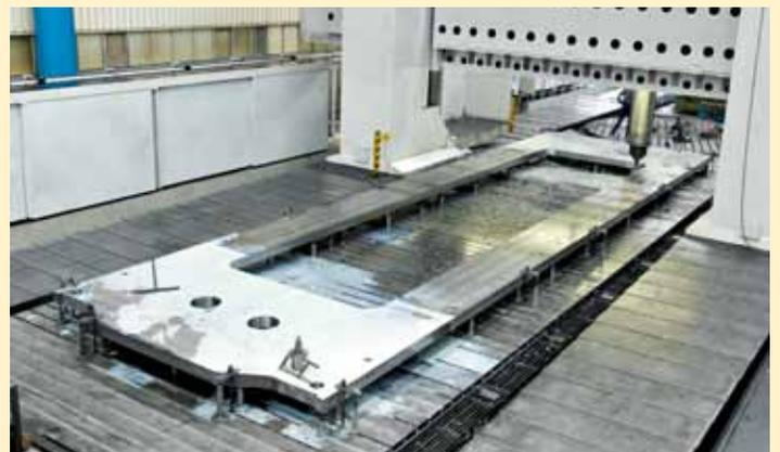
Bearbeitung eines Rahmens für eine Titan-Kompaktierpresse
