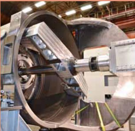
Höchst anspruchsvolle Drehbearbeitung der Passung für eine exakte Montage der Windenergieanlage
