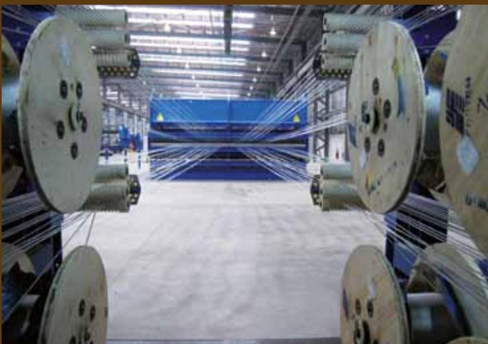
Einlauf der Stahlseile in die Spannstation
