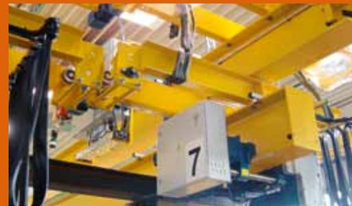
2005: Verriegelungskrane mit Sonderhubwerken in der SKT-Fertigungshalle zum Transport gestapelt
