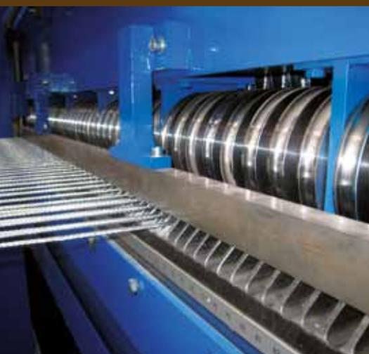
Auslauf Seilspannstation mit Kamm und Umlenkrolle
