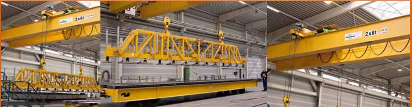
Zweiträgerbrückenkrane mit Lastaufnahmemittel in den Fertigungshallen von BUTTING
