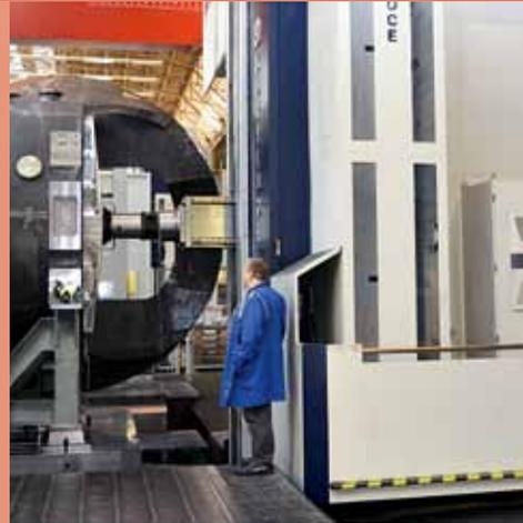
Positionierung des Ausdrehwerkzeugs im Maschinengehäuse
