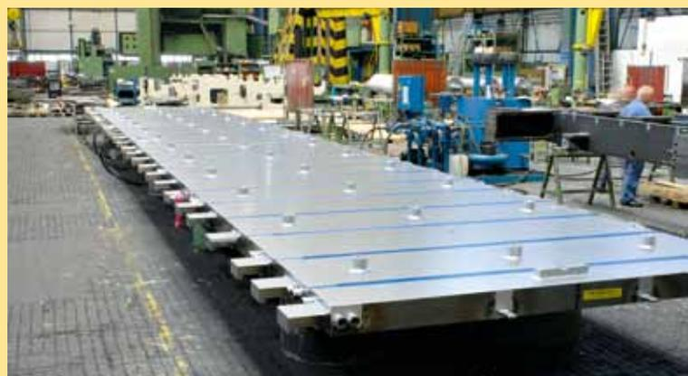
Heizplattenbearbeitung bis 18 m
