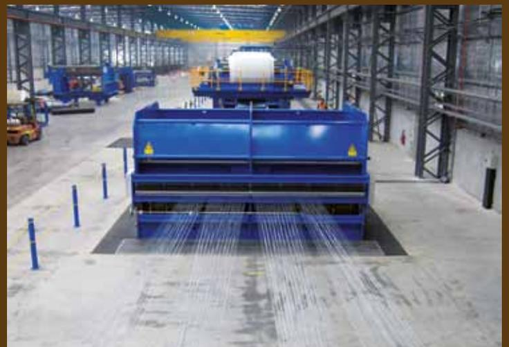
Einlauf vom Seilabwickelgestell in die Seilspannstation
