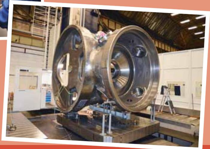
Bereit zum Wenden in der Luft: Maschinengehäuse, mit Anschlagmittel ausgestattet
