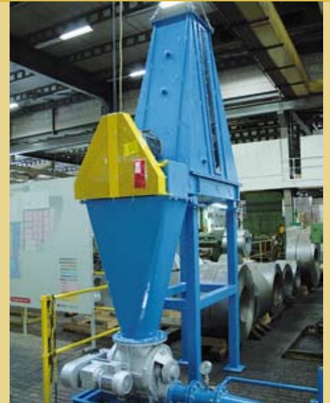
Oben: Büttner-Dosiersilo und Förderstation für staubförmige Brennstoffe Links: Büttner-Erdgasbrenner an einer Trocknungsanlage für Zuckerrübenschnitzel
