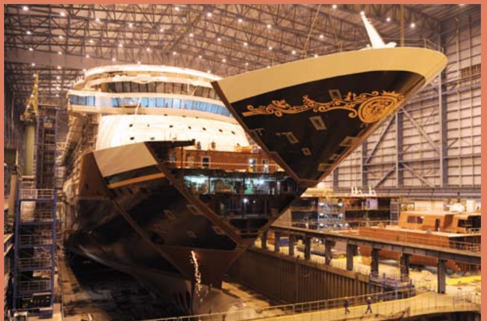
Montage der letzten Schiffssegmente der Disney Dream (Foto: Disney Cruise Line)
