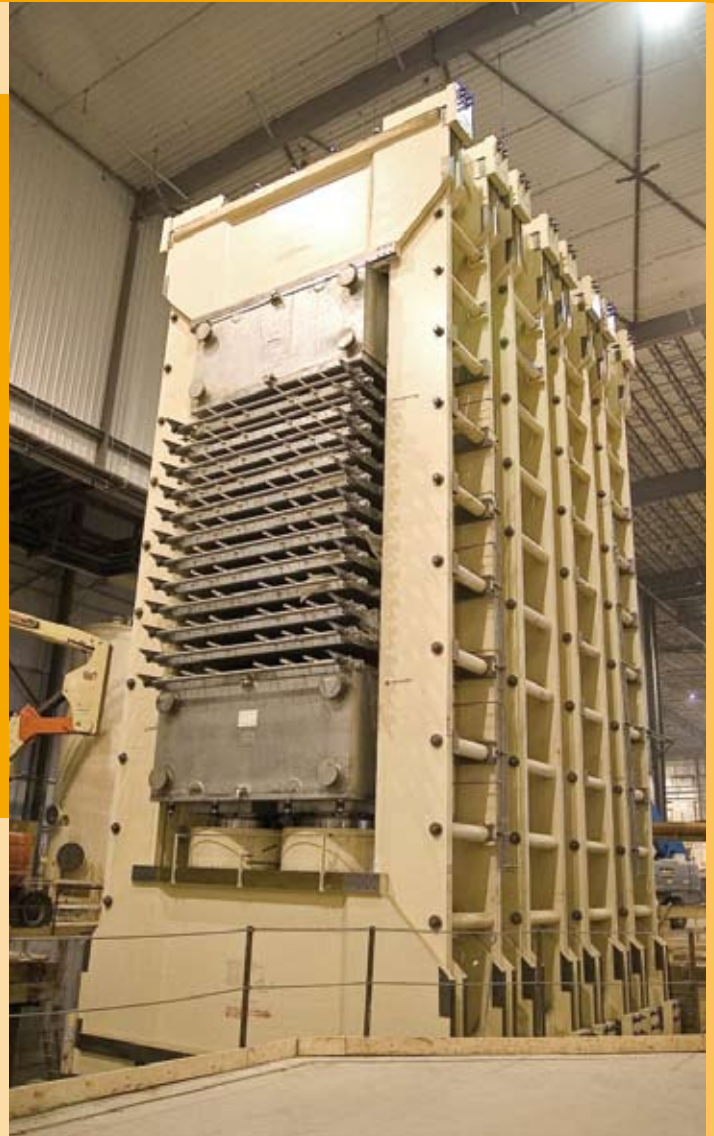
Canfor-LP, 12 Etagen während der Montage
