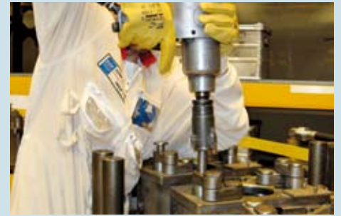
Befestigen von Kuppelmechanismen an der SSM
