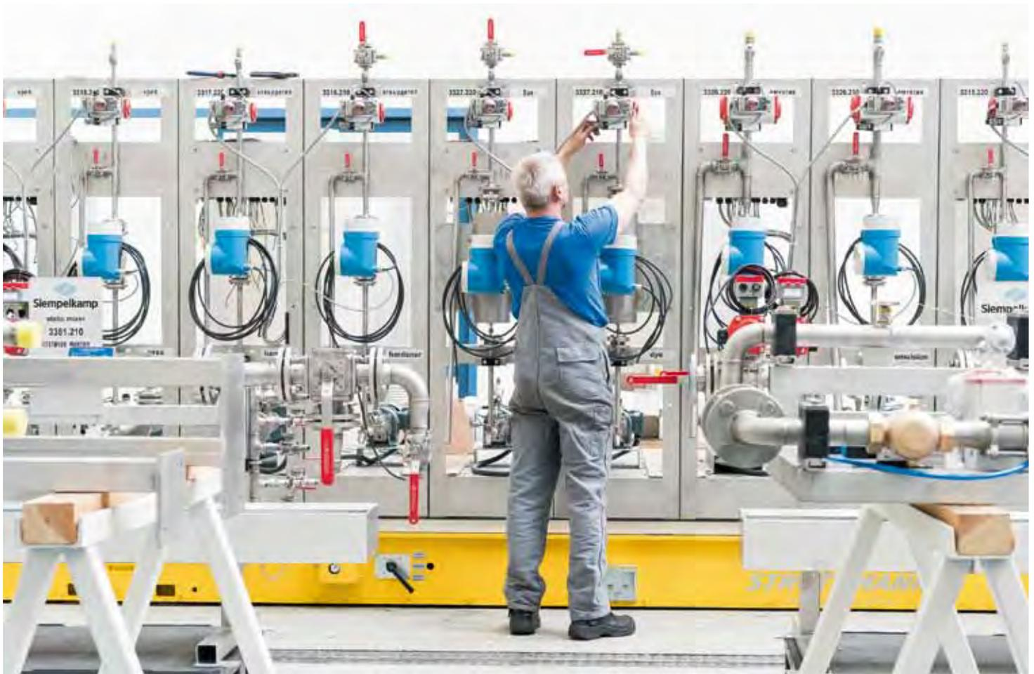
Modular aufgebaute Chemikaliendosierung – Montage
