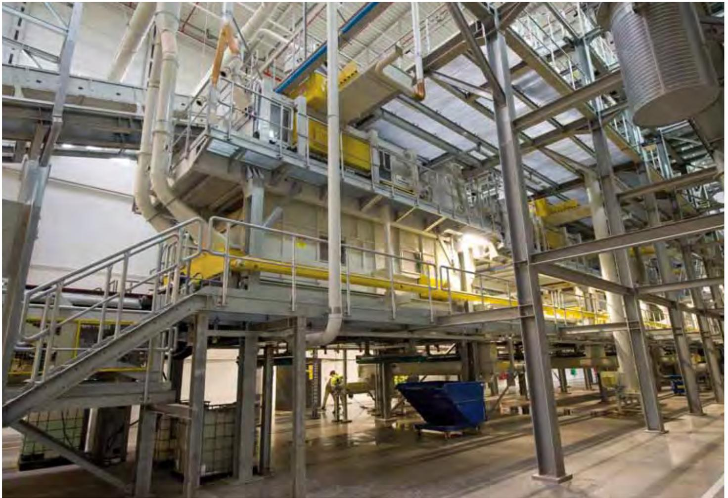
Streumaschine für Span
