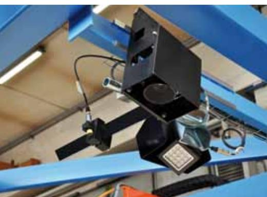
Teilansicht SicoCam – moderne Inline-Plattenvermessung
