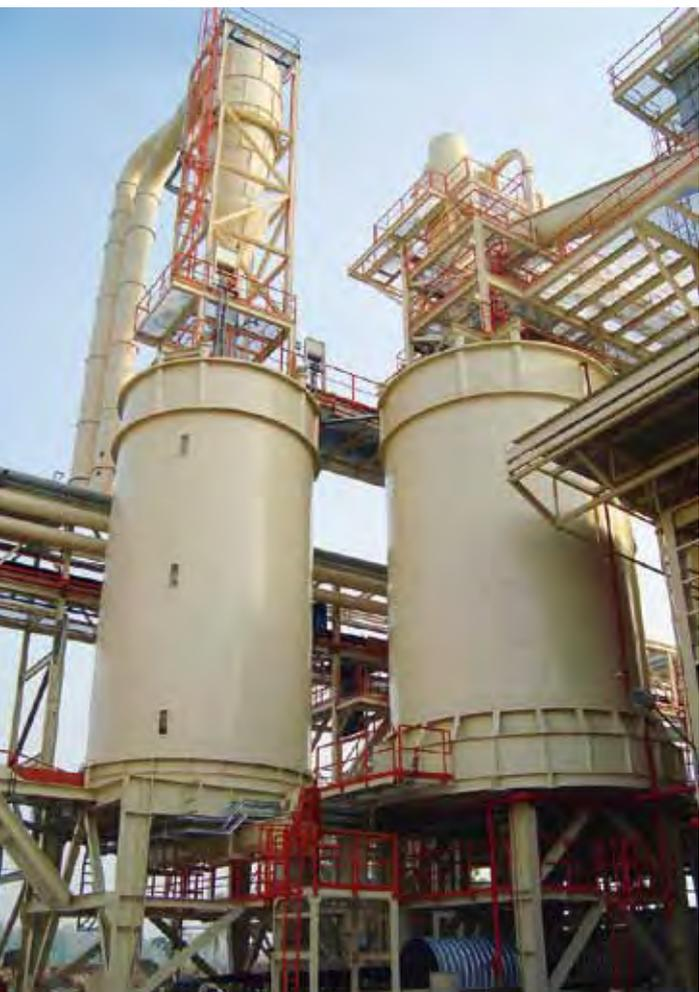
Deck- und Mittelschicht-Spansilos
